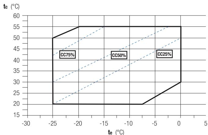
**R134a** motore - motor - motor 1
