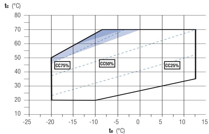
**R404A** motore - motor - motor 2
